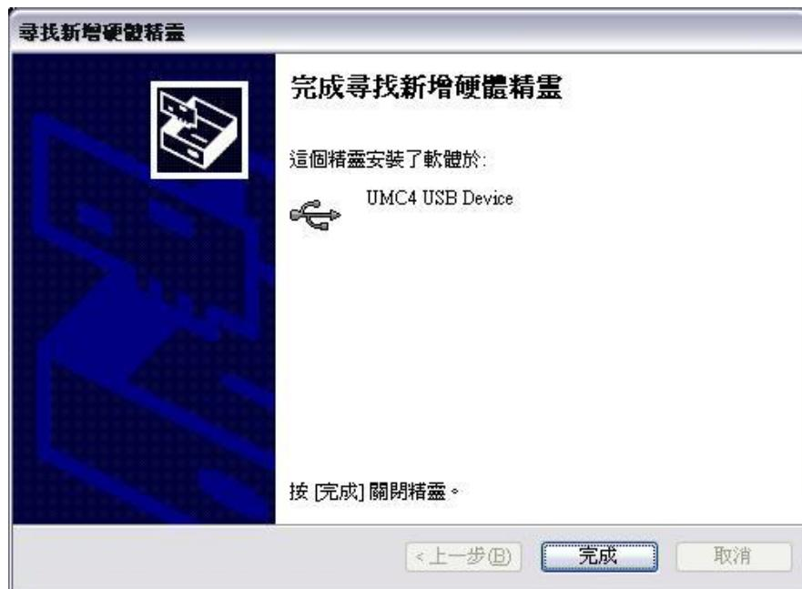
最后 Windows 左下方会跳出「找到新硬件 您的新硬件已安装且已可使用。」，之后您就可以正常使用 UMC4。
